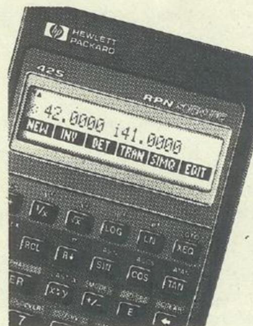
Das Genie unter den technisch-wissenschaftlichen Rechnern: der neue HP-42S von Hewlett-Packard. Er löst Matrixaufgaben und Problemstellungen mit komplexen Zahlen, hat über 600 Funktionen fest eingebaut, einen riesigen Arbeitsspeicher, einen Infrarot-Druckeranschluss und ist HP-41C-programmkompatibel. Lassen Sie sich die Hochleistungsrechner von Hewlett-Packard bei Ihrem Fachhändler vorführen.
